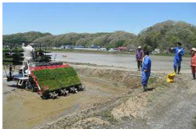
デモ機(GNSS、自動操舵付)による密苗の移植(5/26)
