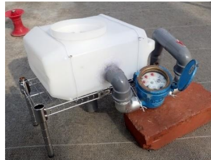
上水道メーターを利用した流量計
