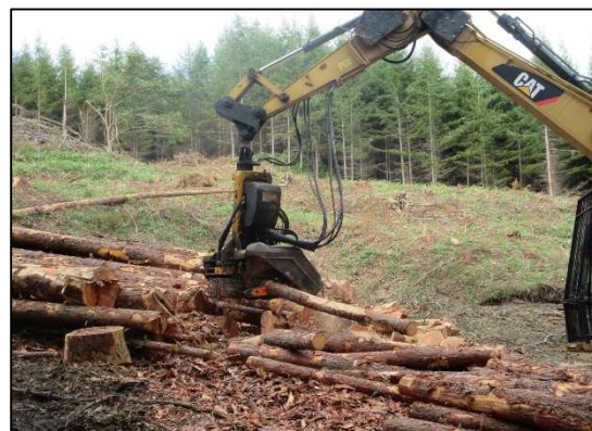
高性能林業機械(ハーベスタ)による玉切り作業 【平取町】
